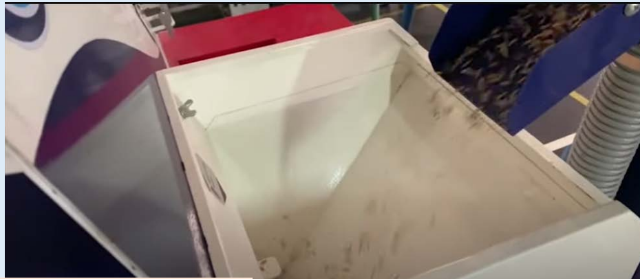
ข้าวที่ทำความสะอาดแล้ว จะถูกส่งไปที่เครื่องสีข้าว
